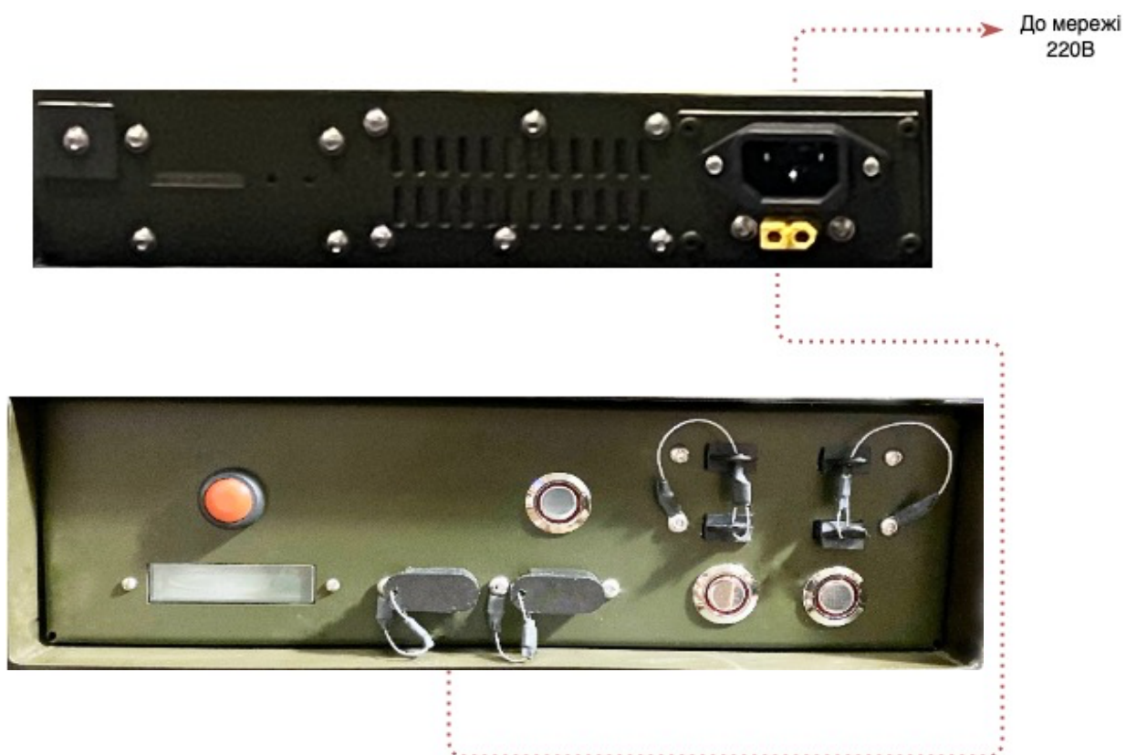
Малюнок 4. Схема підключення для заряду павербанку
