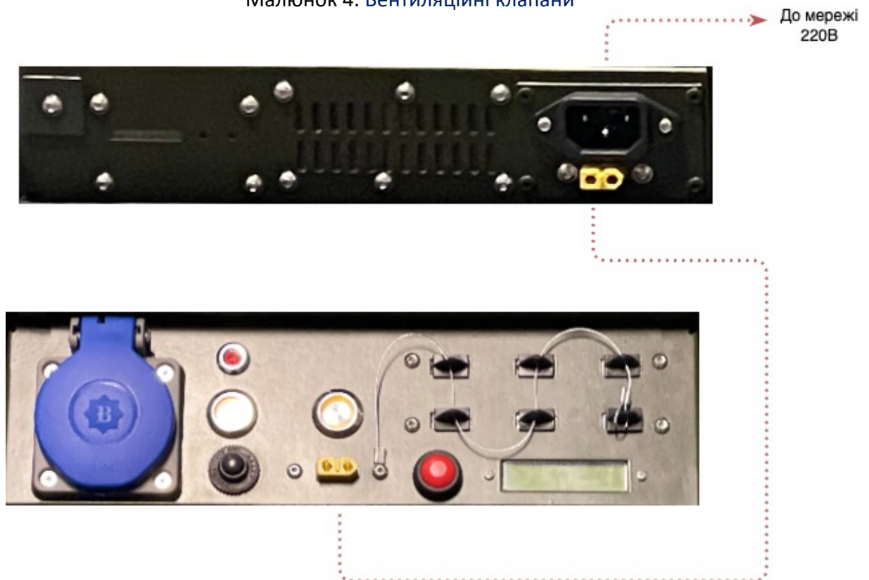
Малюнок 5. Схема підключення для заряду павербанку
